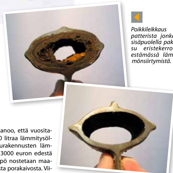
Puhdas patteripinta luovuttaa lämmön vähemmällä ja tasaisesti. Poikkileikkaus patterista Bauerin toimittua.
